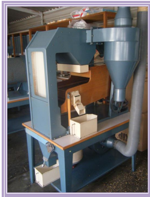
Figura 5. Zaranda para separación de cascarillas de semillas.
