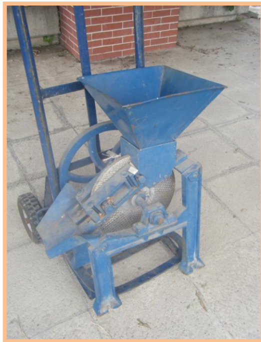
Figura 4. Molino para separar semillas.
